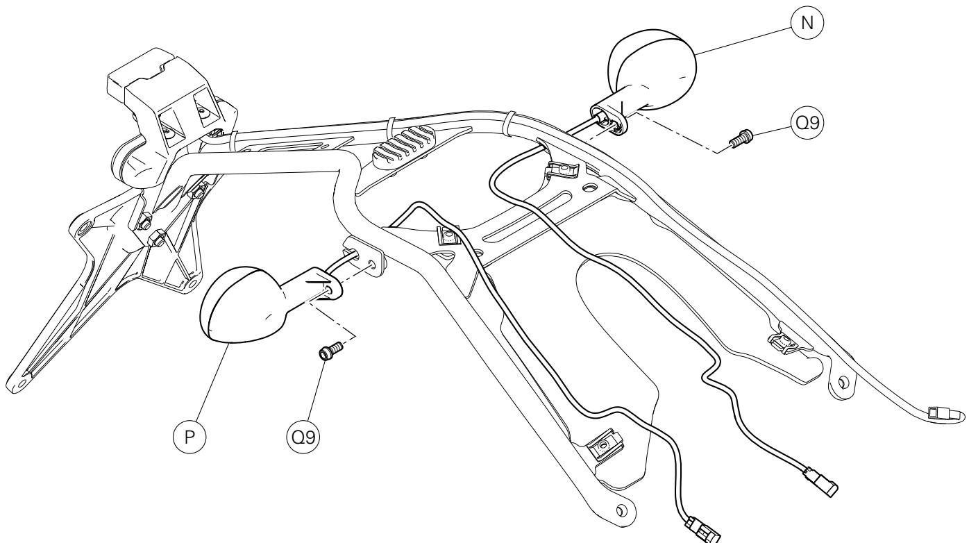
Dépose des clignotants arrière
