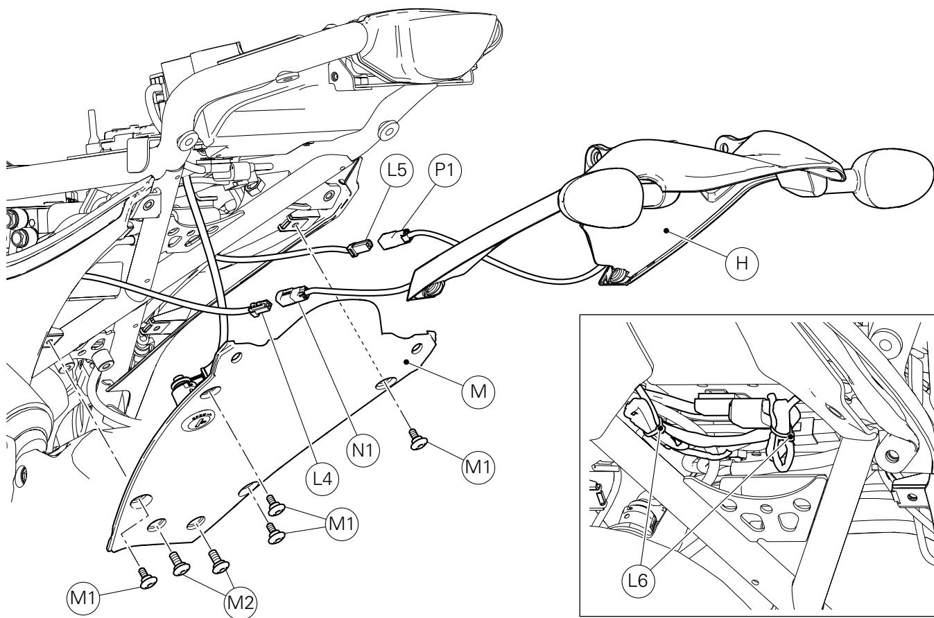
Desatornillar los 4 tornillos (M1) y los 2 tornillos (M2).
