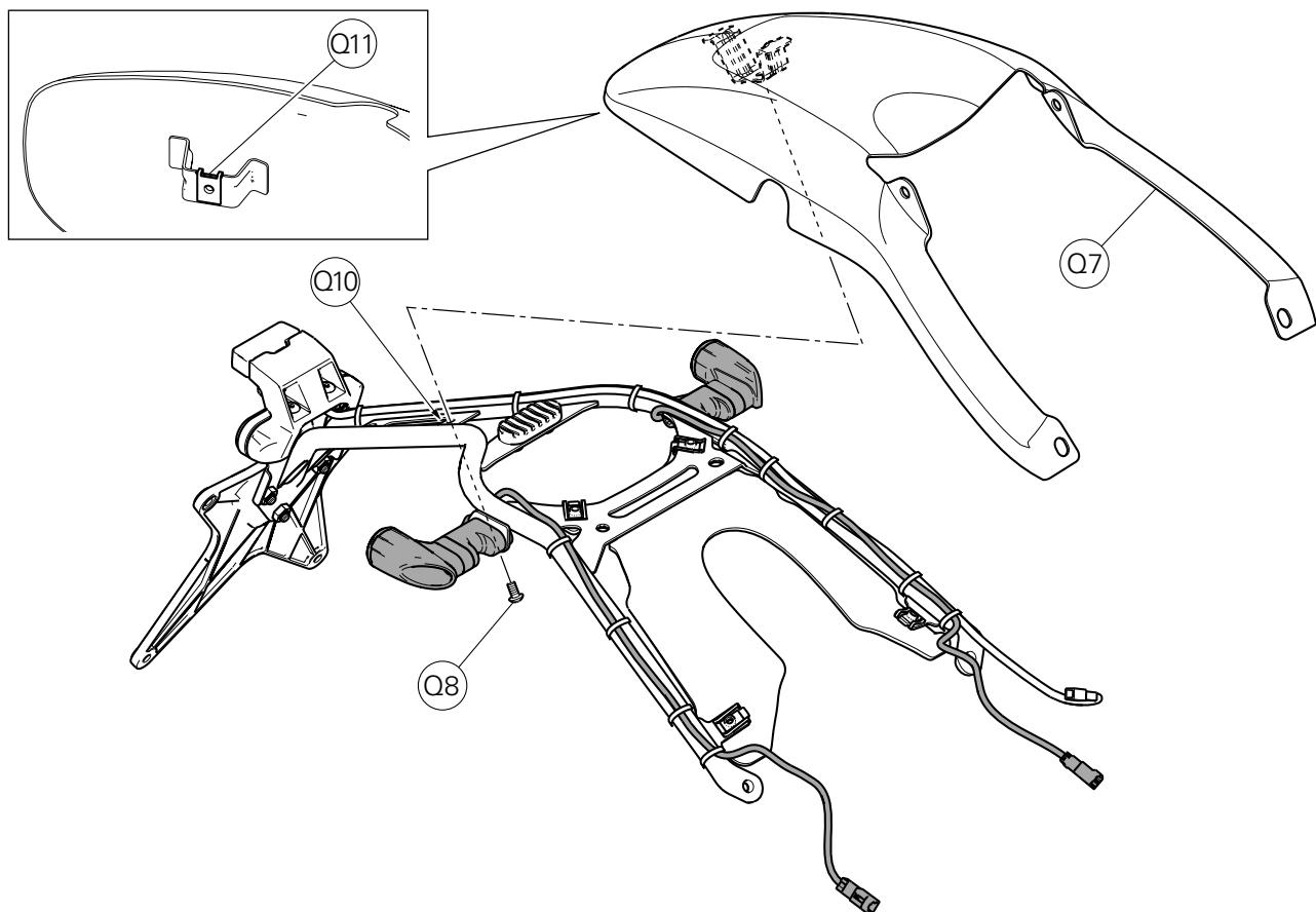
Posicione o guarda-lamas traseiro (Q7) no subchassi traseiro, de modo que o furo (Q10) fique concêntrico com o furo no clip elástico (Q11).
