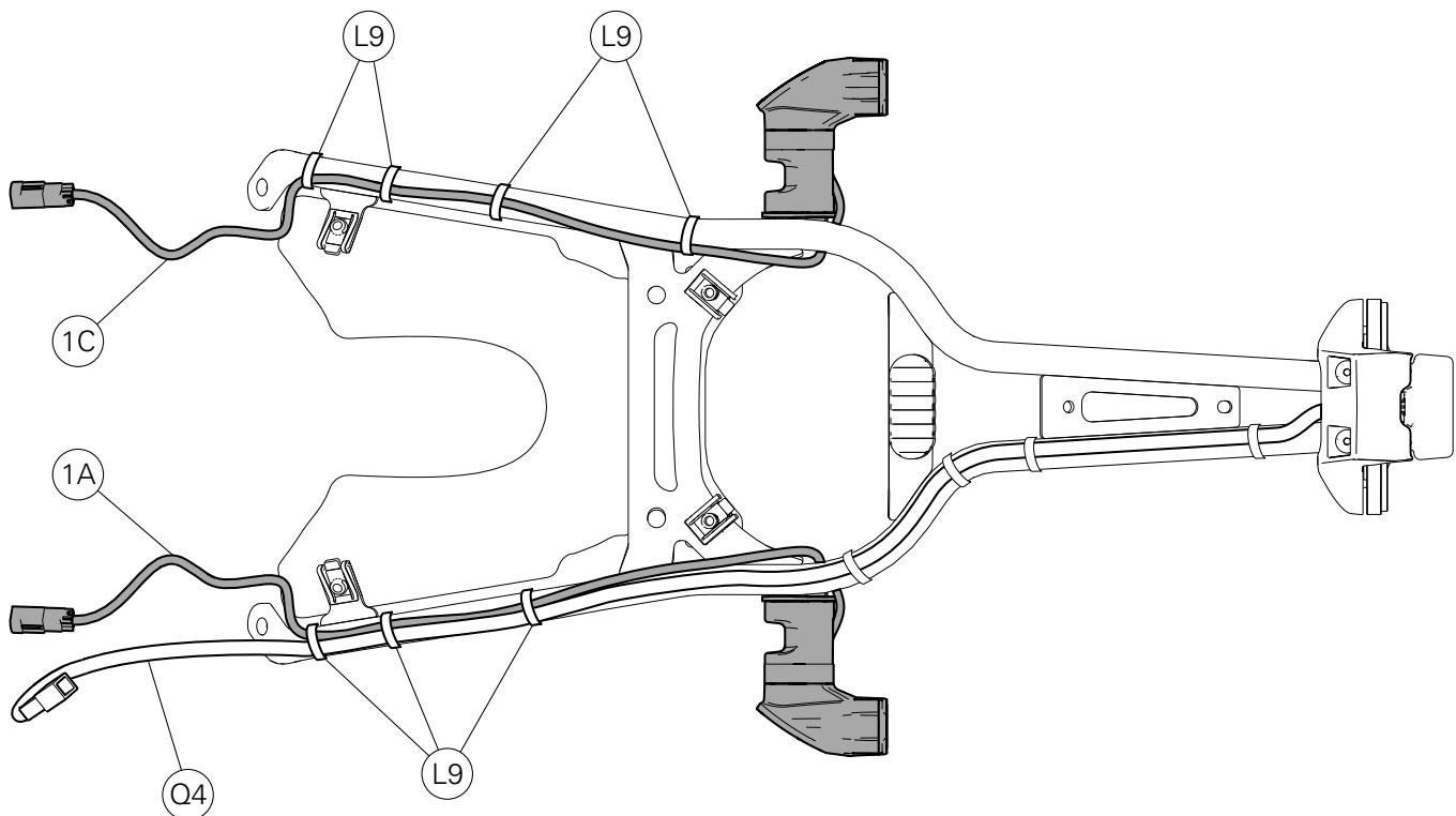
Placer les câblages éclairage plaque d'immatriculation (Q4) et le clignotant de direction gauche (1A) comme la figure le montre, en le bloquant au moyen de 3 grands colliers Rilsan (L9).
