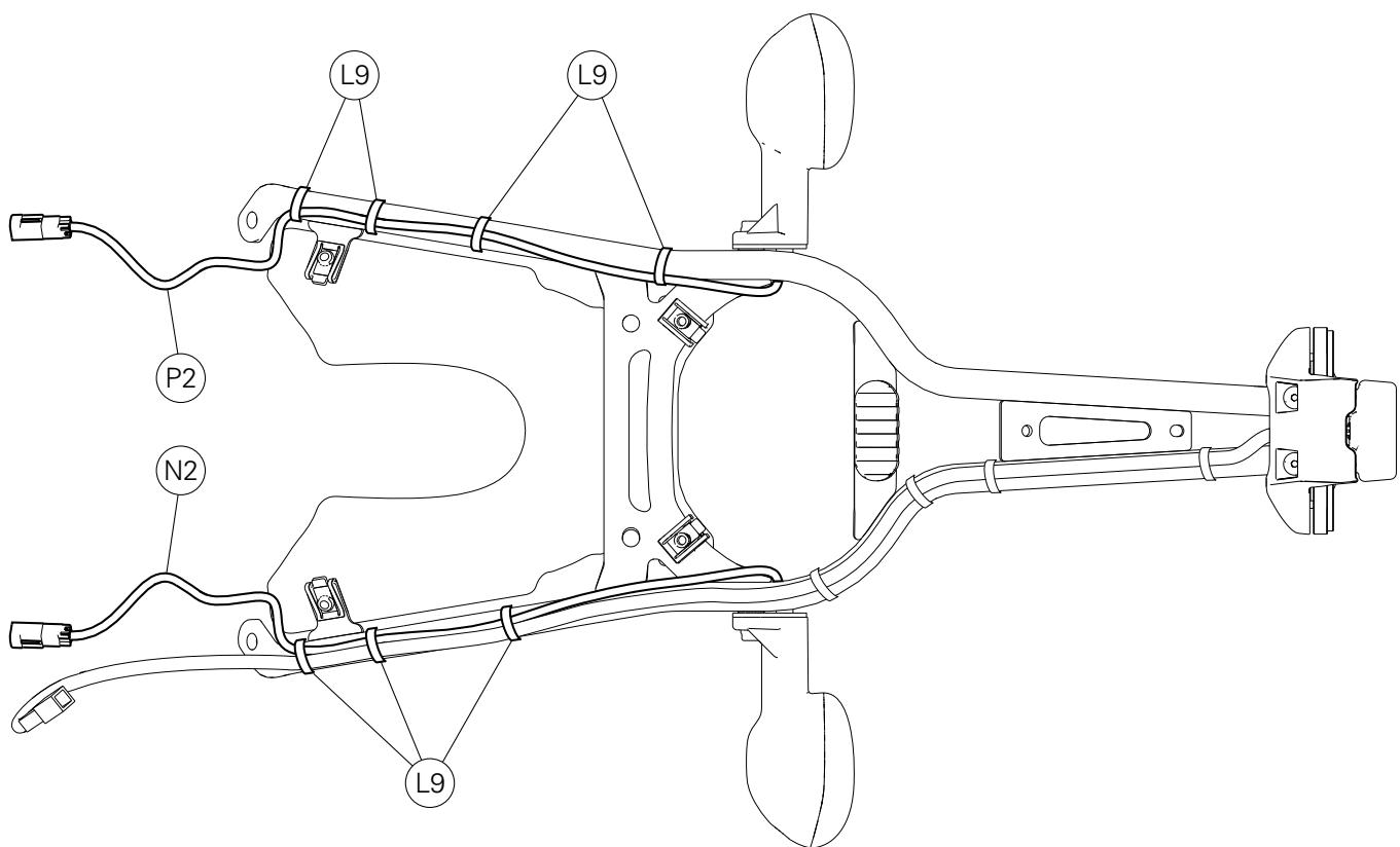
Quitar las 7 abrazaderas de tirón grandes (L9), quitar el cable cableado (N2) indicador de dirección izquierdo y el cable cableado (P2) indicador de dirección derecho.
