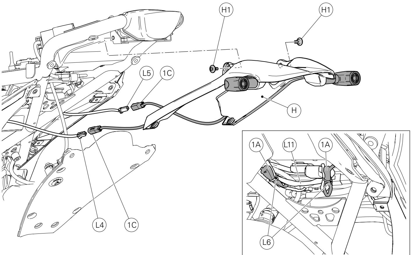
Collegare le n.2 prese (1C) dei cablaggi indicatori di direzioni a led, alle spine (L4) ed (L5) del cablaggio principale.
