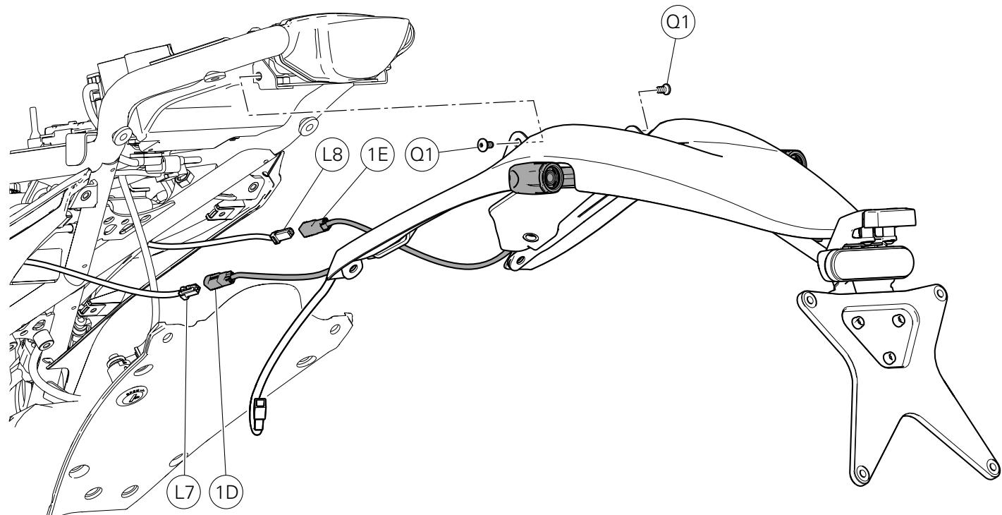
Brancher les prises des câblages clignotant gauche (1D) et droit (1E) sur les fiches (L7) et (L8) du câblage principal.
