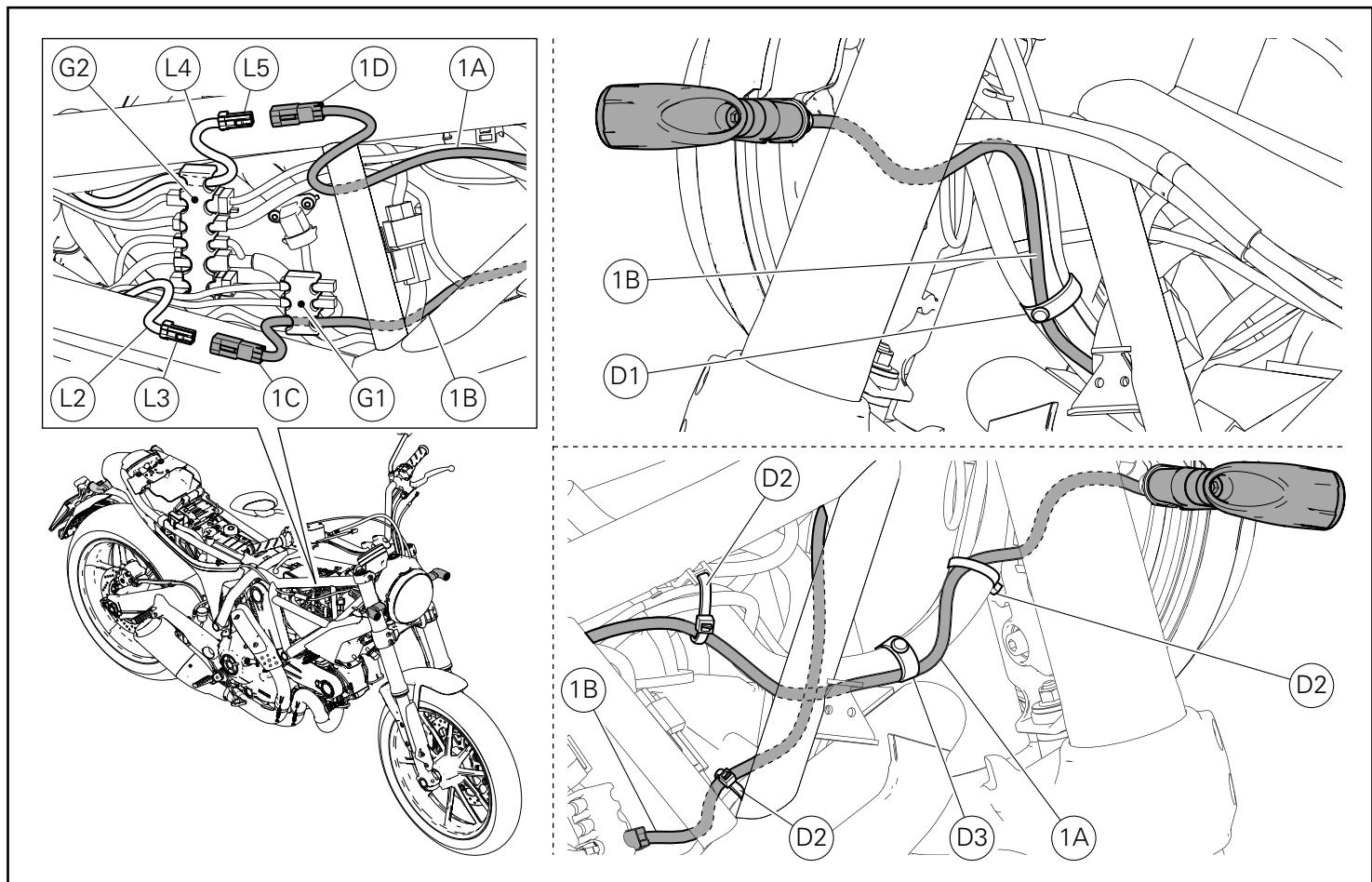
Atuando no lado direito da moto, introduza o cabo da ramificação da cablagem do indicador de direção esquerdo (1B) no tampão (G1) e ligue a ficha (L3) à tomada do conector (1C).
