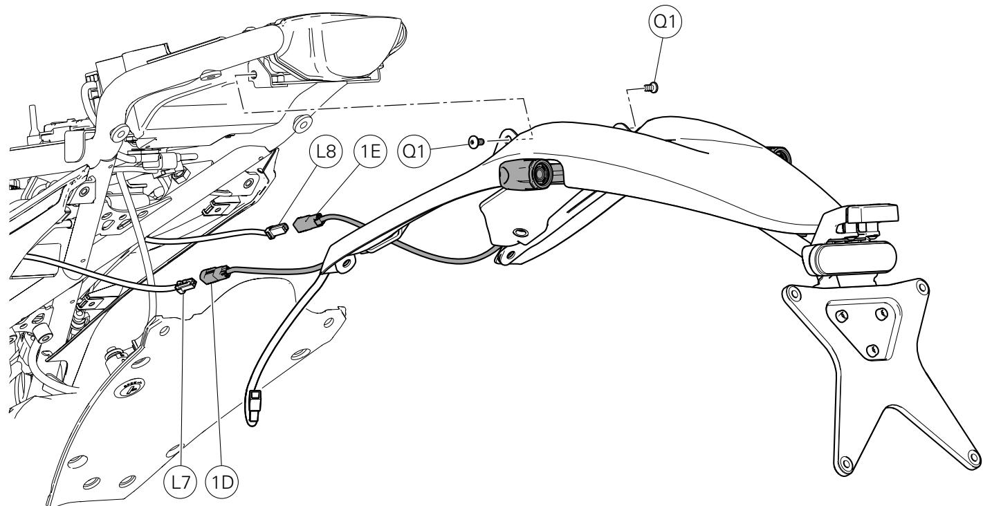
Conectar las tomas de los cableados indicador izquierdo (1D) y derecho (1E) de las clavijas (L7) y (L8) del cableado principal. Colocar el grupo guardabarros trasero/subchasis en el bastidor de la motocicleta.
