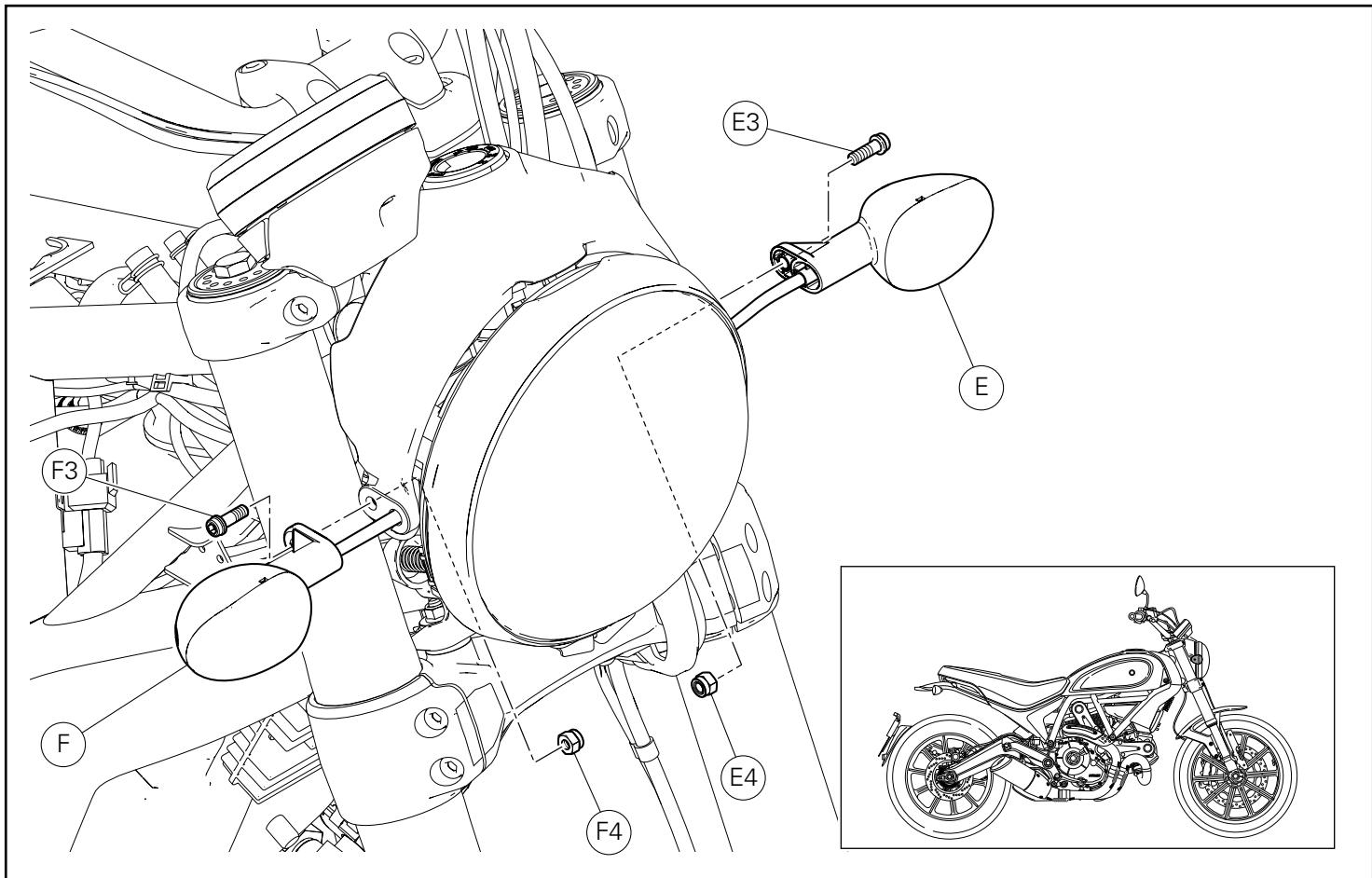
Desatornillar el tornillo (F3) manteniendo, del lado opuesto, la tuerca (F4).
