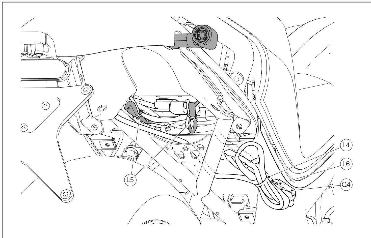
Fijar el cable indicador izquierdo al cable de faro trasero con una abrazadera de tirón pequeña (L5).
