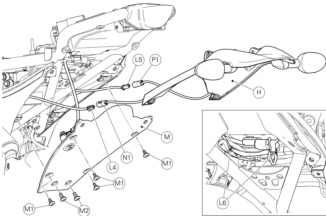
Desserrer les 4 vis (M1) et les 2 vis (M2).
