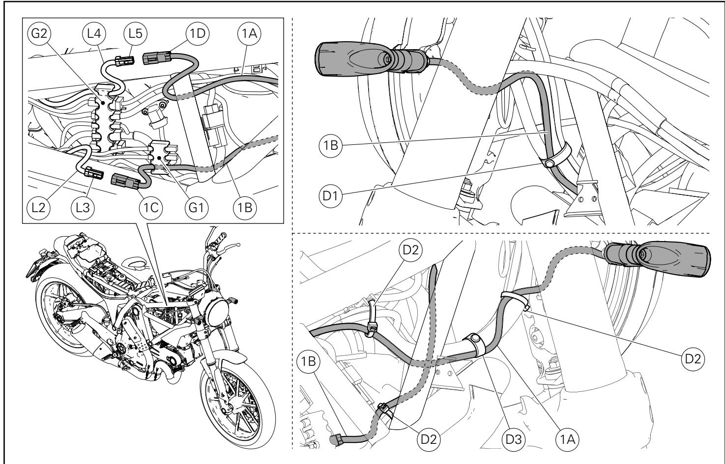
Operando sul lato destro del motoveicolo, introdurre il cavo ramo cablaggio indicatore di direzione sinistro (1B) sul tampone (G1) e collegare la spina (L3) alla presa connettore (1C).
