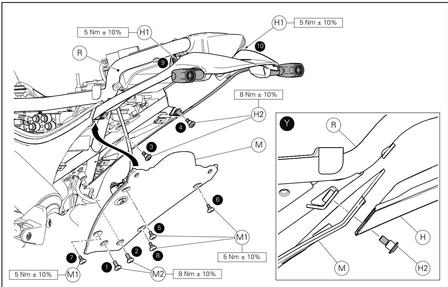
Placer le cache dessous-de-selle (M) entre le cadre (R) et l'ensemble garde-boue arrière, comme la figure (Y) le montre. Enduire de LOCTITE 243 et présenter les 2 vis (H2) sur l'ensemble garde-boue arrière (H).
