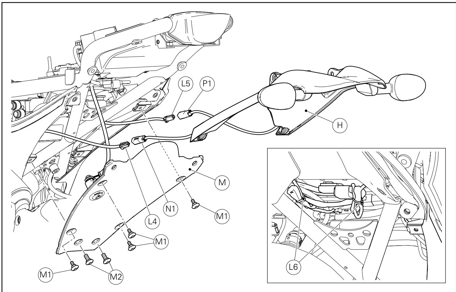
Desatarraxe os 4 parafusos (M1) e os 2 parafusos (M2).
