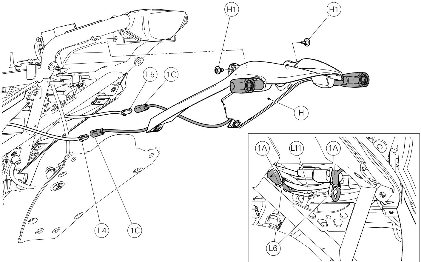
Brancher les 2 prises (1C) des faisceaux clignotants à LED aux fiches (L4) et (L5) du câblage principal.
