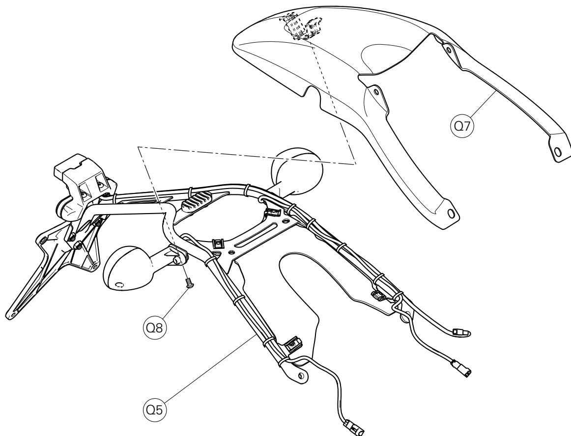
Desserrer la vis (Q8) et déposer le garde-boue (Q7) du sous-cadre support de plaque d'immatriculation (Q5).
