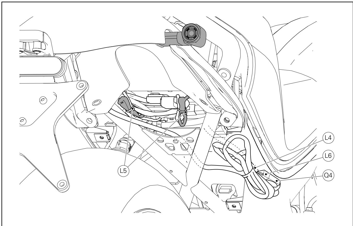
Fixe o cabo do indicador esquerdo ao cabo do farol traseiro com uma braçadeira de serrilha pequena (L5).
