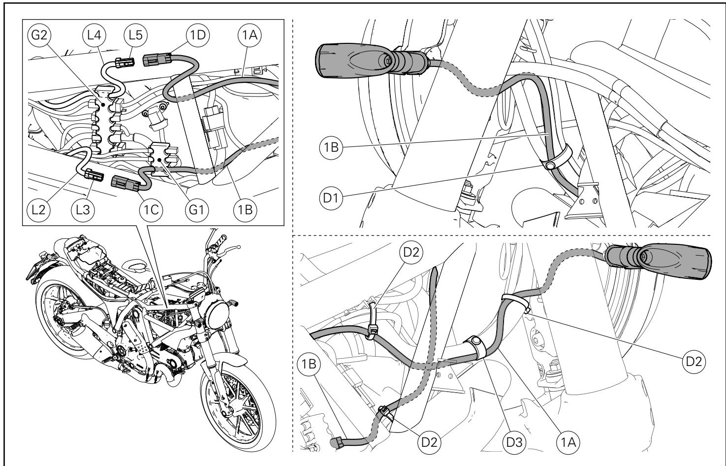
En intervenant du côté droit du motocycle, insérer le câble du brin câblage clignotant gauche (1B) dans le tampon (G1) et brancher la fiche (L3) à la prise connecteur (1C).
