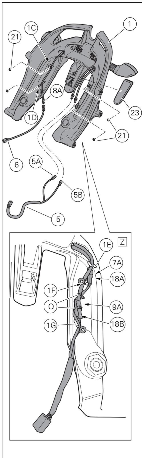
Enlever la pellicule de protection présente sur le côté arrière du catadioptre (23). Appliquer le catadioptre (23) sur le sous-cadre support valises (1), en appuyant uniformément sur toute la surface du catadioptre (23) même.
