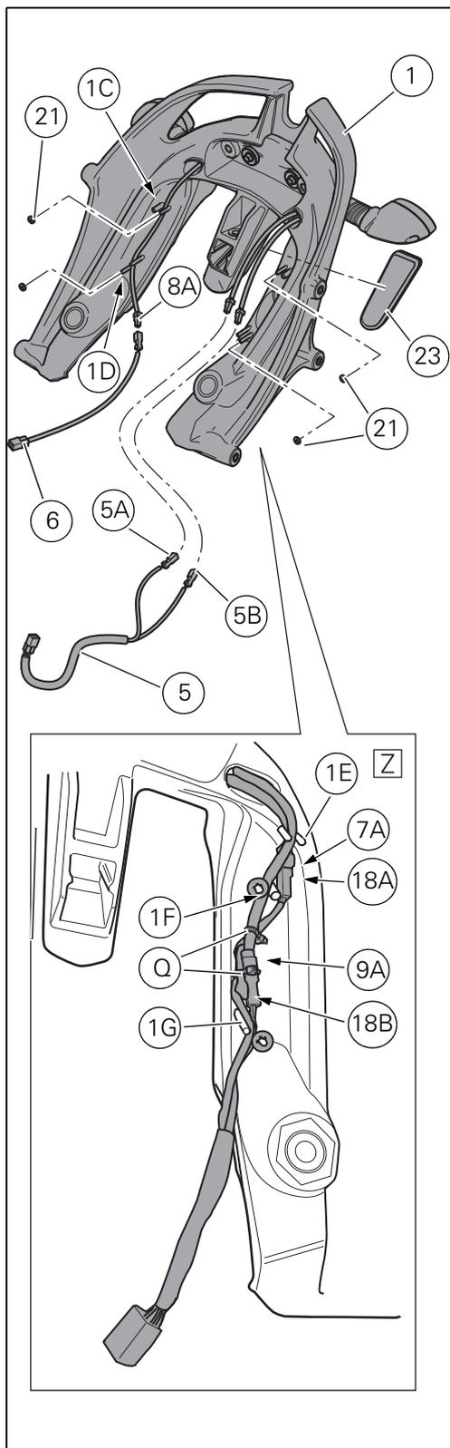
Rimuovere la pellicola protettiva presente sul lato posteriore del catadiottro (23). Applicare il catadiottro (23) sul telaio supporto borse (1), premendo uniformemente su tutta la superficie del catadiottro (23) stesso.
