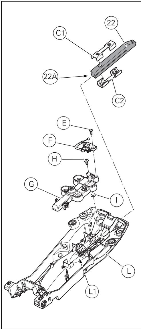
Posizionare la guida inferiore maniglione originale (C2) sulla vasca portaoggetti (L), portandola in appoggio sul dentino di fermo (L1).
