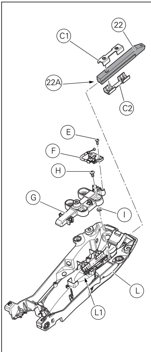
Positionner le guide inférieur poignée passager d'origine (C2) sur le bac vide-poches (L), en le portant en appui sur l'ergot d'arrêt (L1).
