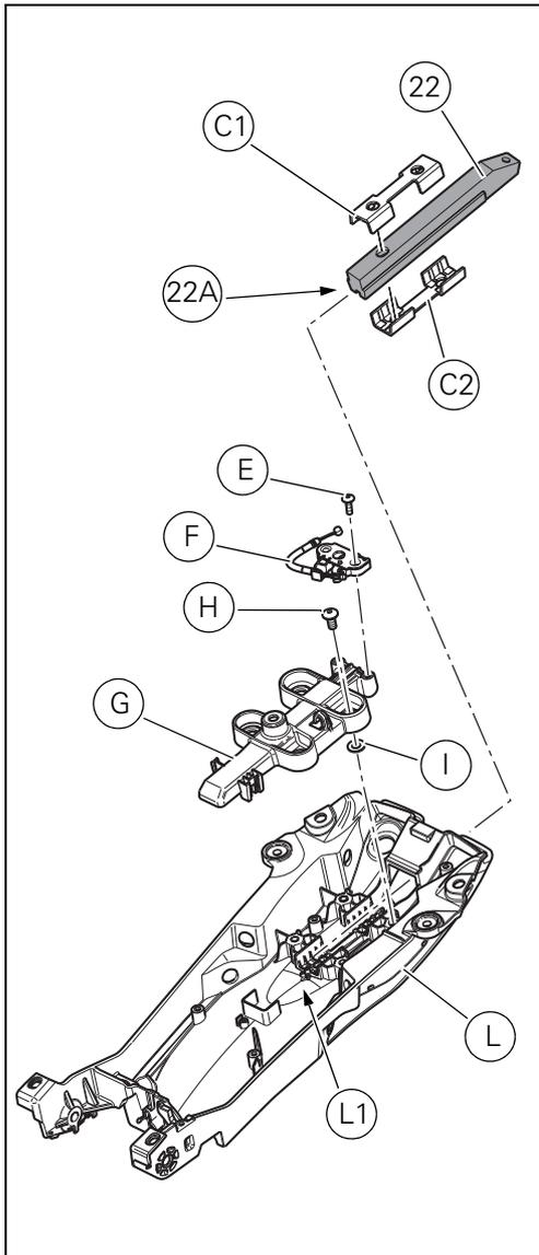
Posicione a guia inferior da pega original (C2) no compartimento porta-objetos (L), apoiando-a no dente de retenção (L1). Insira, até encostar no dente de retenção (L1), a cavidade (22A) da pega (22) através da abertura existente no compartimento porta-objetos (L).
