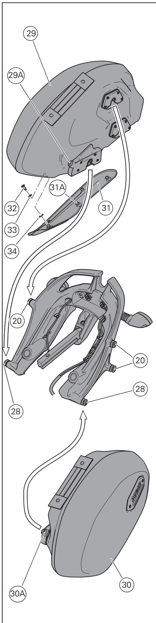
Abra a bolsa direita (29) e retire o revestimento interno.
