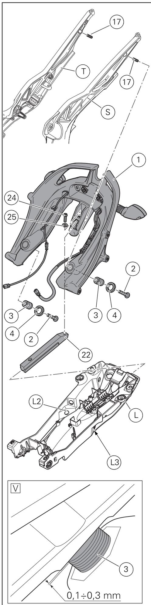
Présenter manuellement jusqu'en butée les 2 vis TCHCF (17) de service dans les deux trous inférieurs des sous-cadres (S) et (T) du véhicule.
