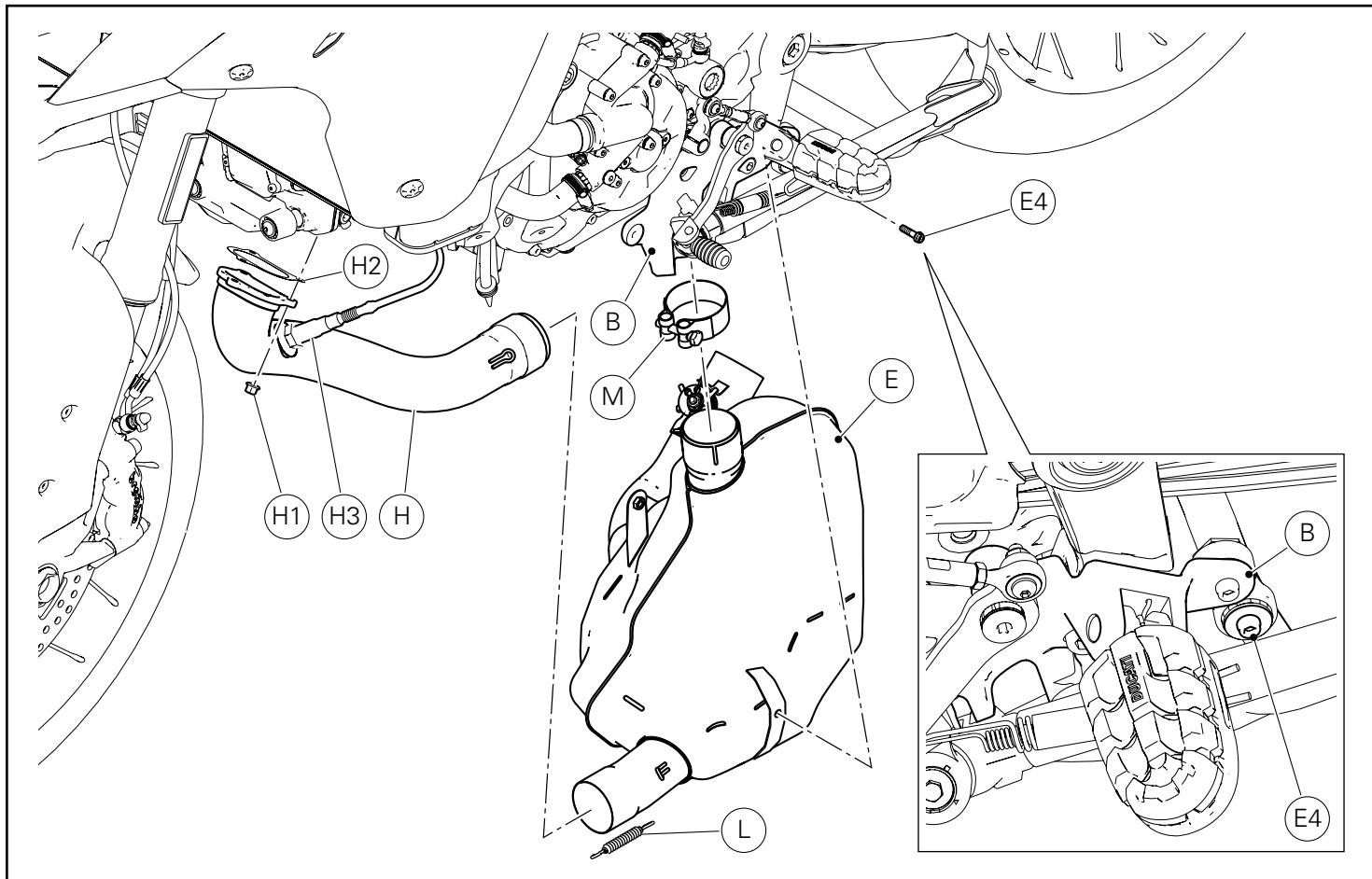
Operando desde el lado izquierdo de la moto, desmontar el muelle (L) utilizando un tensor de muelles comercial.
