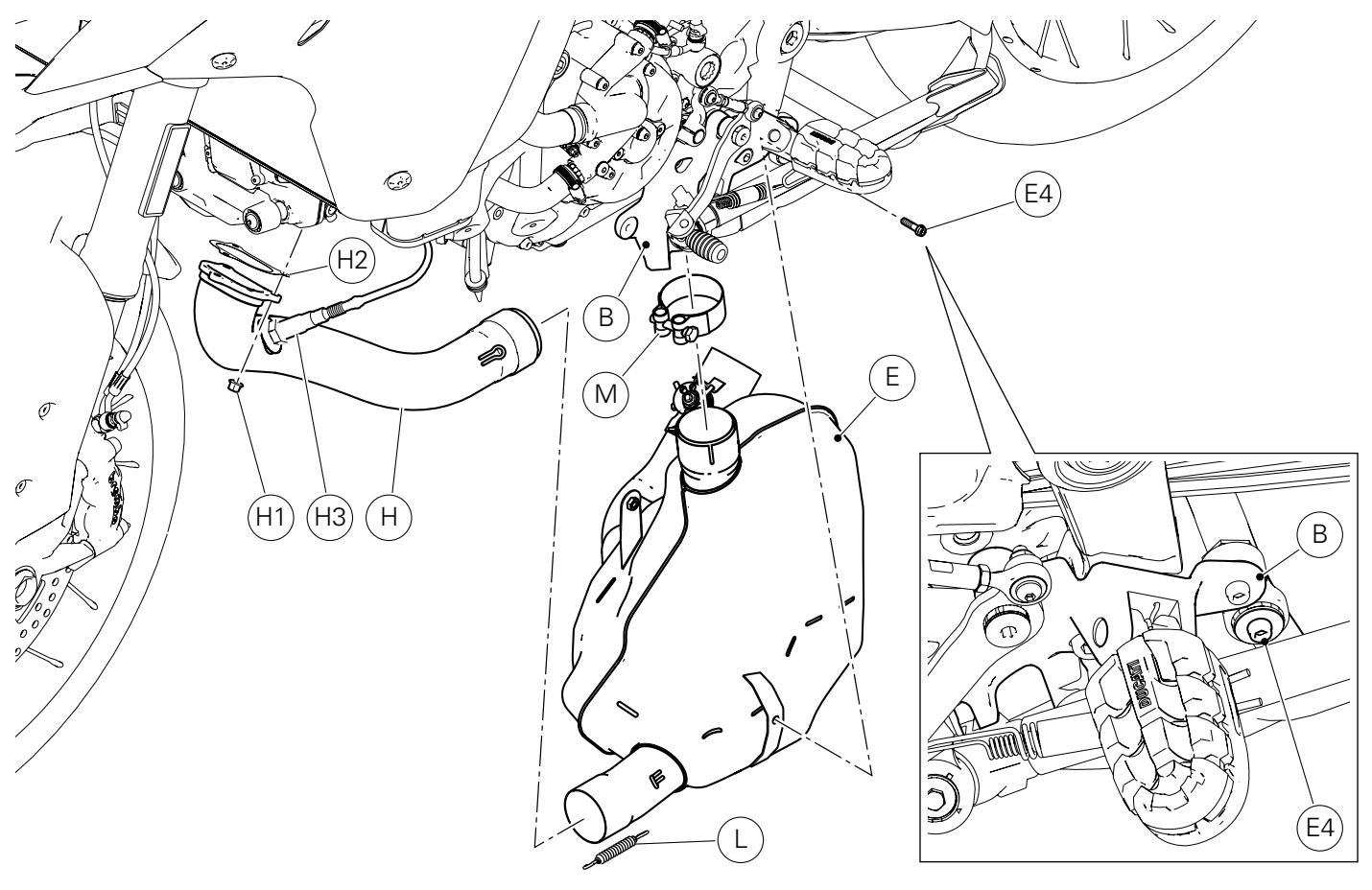
Operando sul lato sinistro del motoveicolo, smontare la molla (L) utilizzando un tiramolle commerciale.
