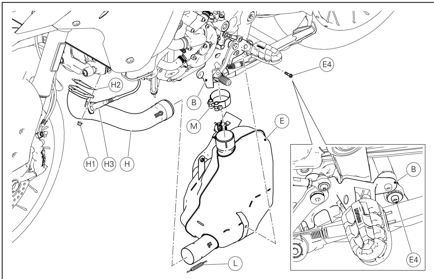
En intervenant du côté gauche du motocycle déposer le ressort (L) à l'aide d'un tire-ressort disponible dans le commerce.
