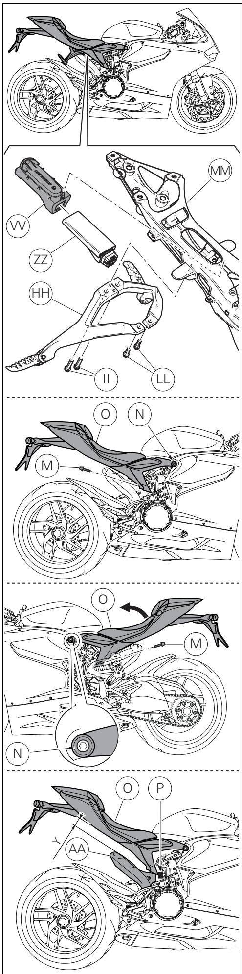
Smontare il gruppo pedane posteriori (HH) dal telaietto (MM) svitando le n.2 viti M8x30mm (II) e le n.2 viti M8x20mm (LL). Smontare il supporto Black Box (VV) dal telaietto, scollegare il connettore di alimentazione Black Box e rimuovere la centralina Black Box (ZZ) dal supporto (VV). Smontare le viti inferiori (M) e allentare le viti superiori (N) di fissaggio gruppo telaietto posteriore (O).
