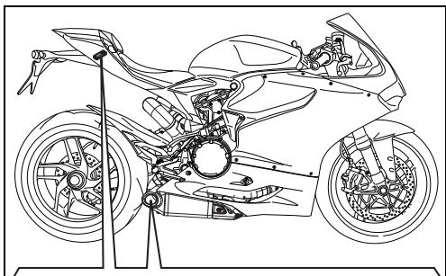
Applicare sulla centralina Black Box (ZZ) il termoisolante (1) centrando la mezzeria del termoisolante rispetto la mezzeria della centralina e farla aderire premendola con decisione per tutta la sua superficie. Inserire la centralina Black Box (ZZ) appena termoisolata nel supporto Black Box (VV). Collegare il connettore di alimentazione Black Box e rimontare il gruppo centralina Black Box (ZZ) nel telaietto.
