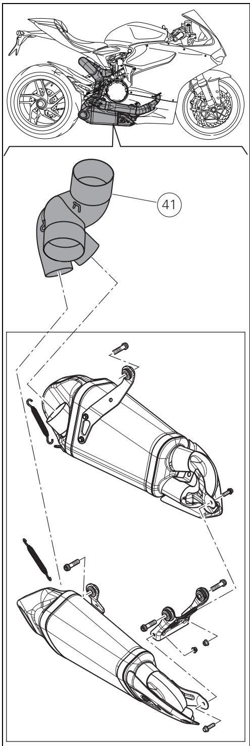
Insérer l'ensemble silencieux dans le corps central (41) jusqu'en butée.
