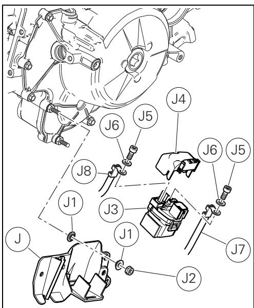
Déposer les colliers et sortir le solénoïde (J3) des languettes présentes sur le support (J). Déposer le capuchon de protection (J4) du solénoïde (J3).
