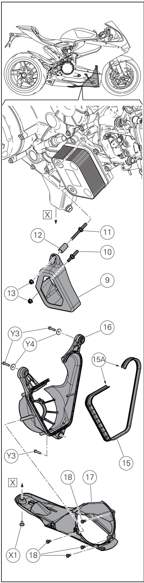
Monte o extrator de ar traseiro (17) no extrator de ar dianteiro (16), atarraxando e apertando os 4 parafusos (18) a um binário de aperto de  $4\pm10\%$  Nm.
