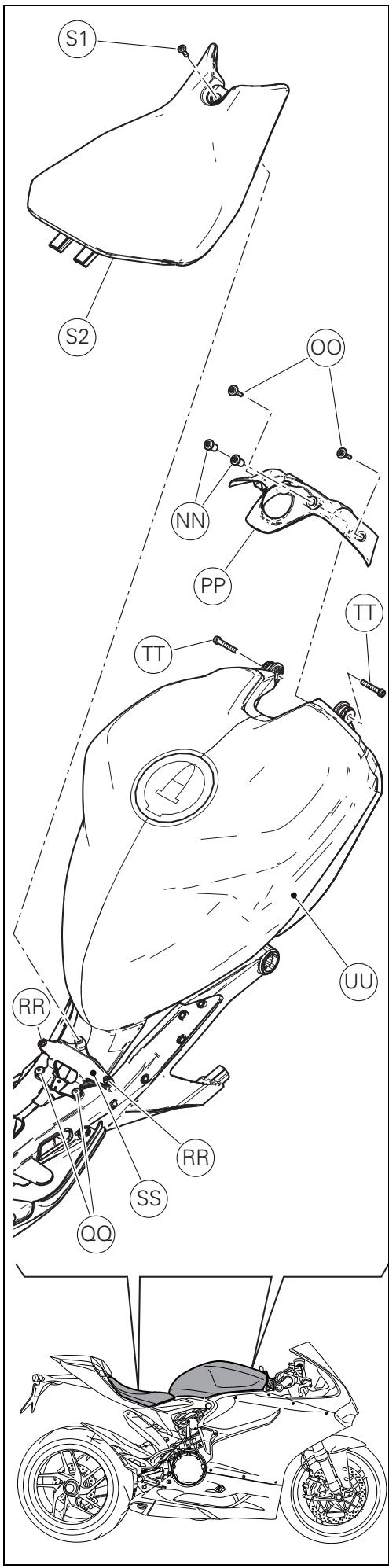
Desatarraxe o parafuso (S1) e remova o assento do condutor (S2), retirando-o pela parte dianteira da moto.
