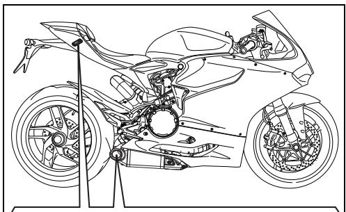
Appliquer sur le boîtier électronique Black Box (ZZ) l'isolant thermique (1), en centrant la ligne médiane de l'isolant thermique par rapport avec celle du boîtier électronique et le faire adhérer en exerçant une forte pression sur toute sa surface. Insérer le boîtier électronique Black Box (ZZ) qui vient d'être isolé thermiquement dans le support Black Box (VV). Brancher le connecteur d'alimentation Black Box et reposer l'ensemble boîtier électronique Black Box (ZZ) dans le sous-cadre.
