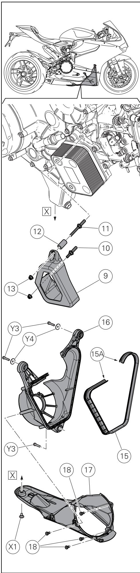
Premontare l'estrattore aria posteriore (17) sull'estrattore aria anteriore (16) avvitando e serrando le 4 viti (18) alla coppia di serraggio  $4\pm10\% \text{ Nm}$ .
