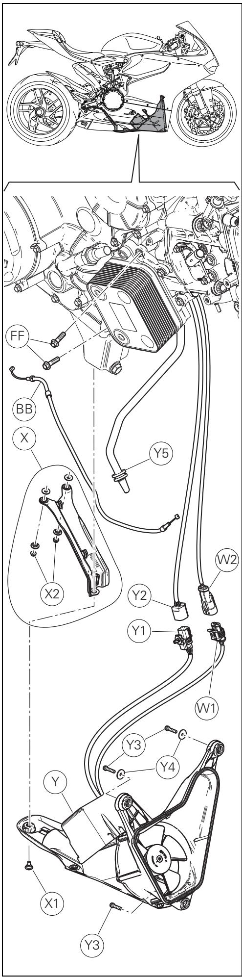
Desligue as fichas (Y1) e (W1) das tomadas (Y2) e (W2) (correspondentes respetivamente à ligação do motor da válvula de escape e da ventoinha elétrica). Desatarraxe o parafuso (X1), as porcas (X2) e remova o grupo da proteção anti-calor da válvula de escape (X).
