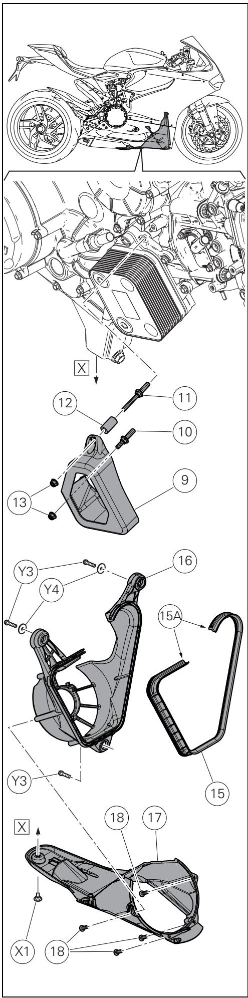
Montar el extractor de aire trasero (17) en el extractor de aire delantero (16) atornillando y ajustando los 4 tornillos (18) al par de apriete de  $4\pm10\% \text{ Nm}$ .
