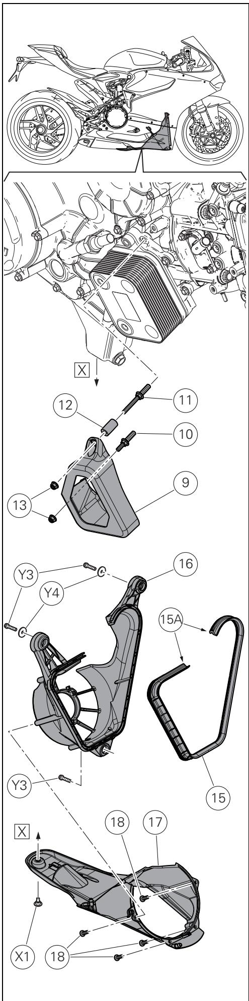
Pré-monter l'extracteur d'air arrière (17) sur l'extracteur d'air avant (16) en vissant et en serrant les 4 vis (18) au couple de serrage de  $4 \pm 10\% \text{ Nm}$ .
