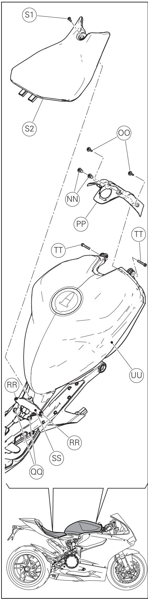
Destornillar el tornillo (S1) y quitar el asiento del piloto (S2) extrayéndolo hacia la parte delantera de la moto.
