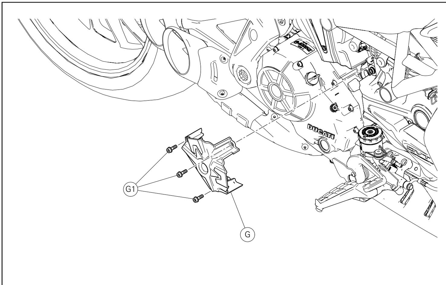
Desmontaje lámina cubre correa central
