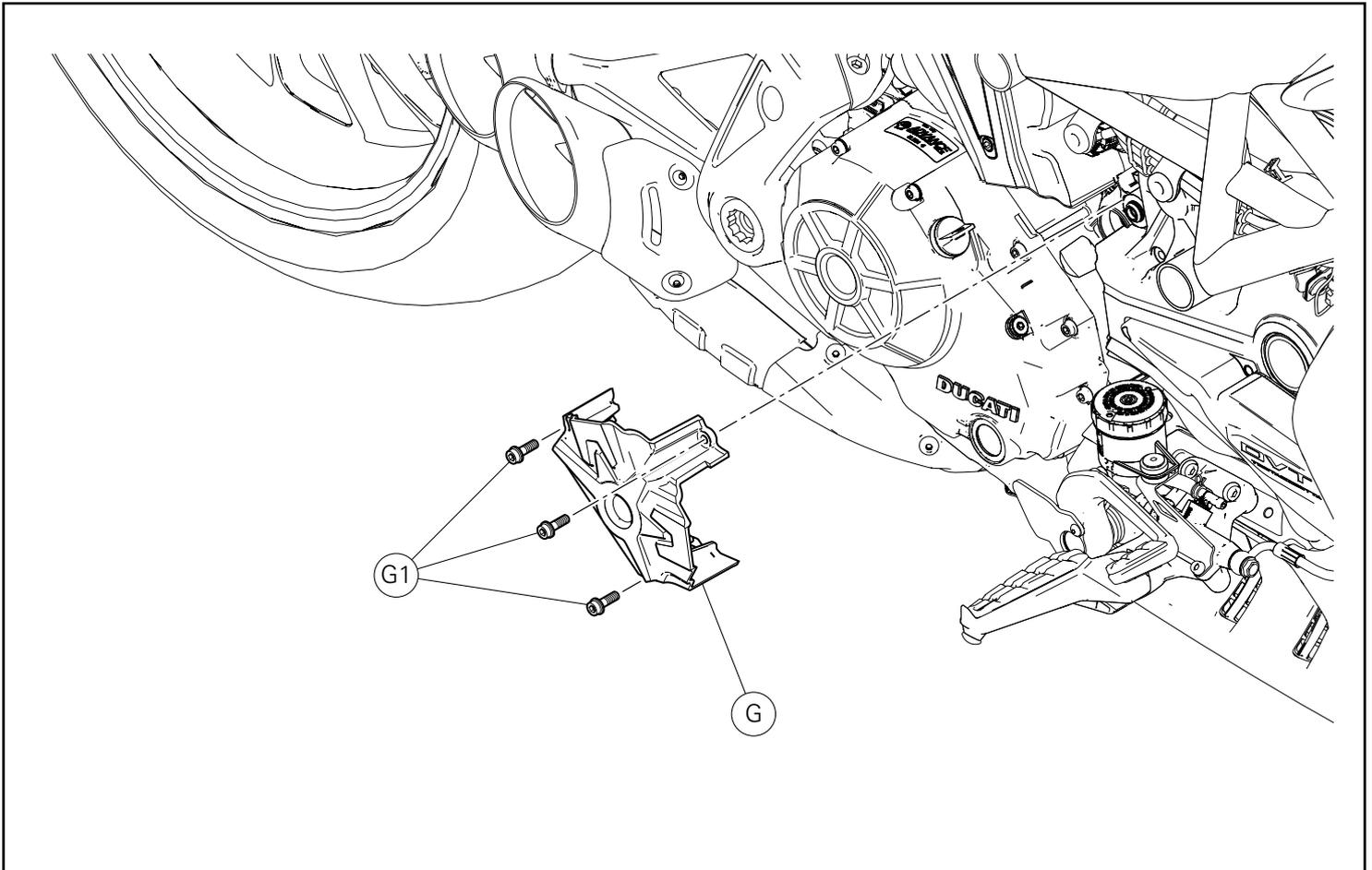
Dépose couvercle courroie centrale
